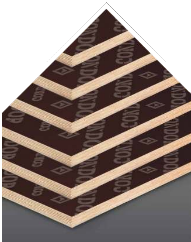
Placă tip plywood cu acoperire phenolică (acoperirea cu rezină phenolică de minim 220g/mp conferă rezistență extremă la umiditate și șocuri, conform EN 314-2/CLASS 3).
